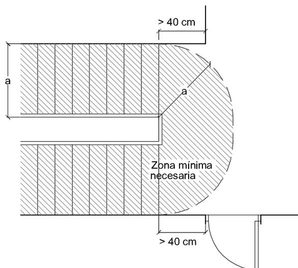
Figura 4.4 Cambio de dirección entre dos tramos.
