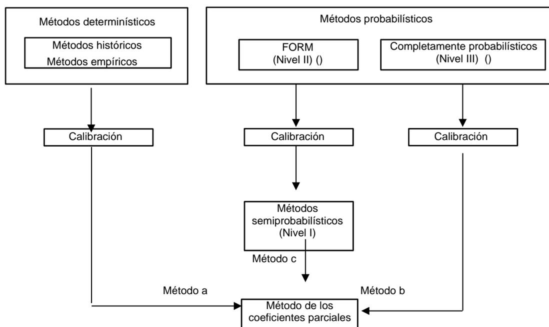
Figura C1 – Resumen de los métodos de fiabilidad
