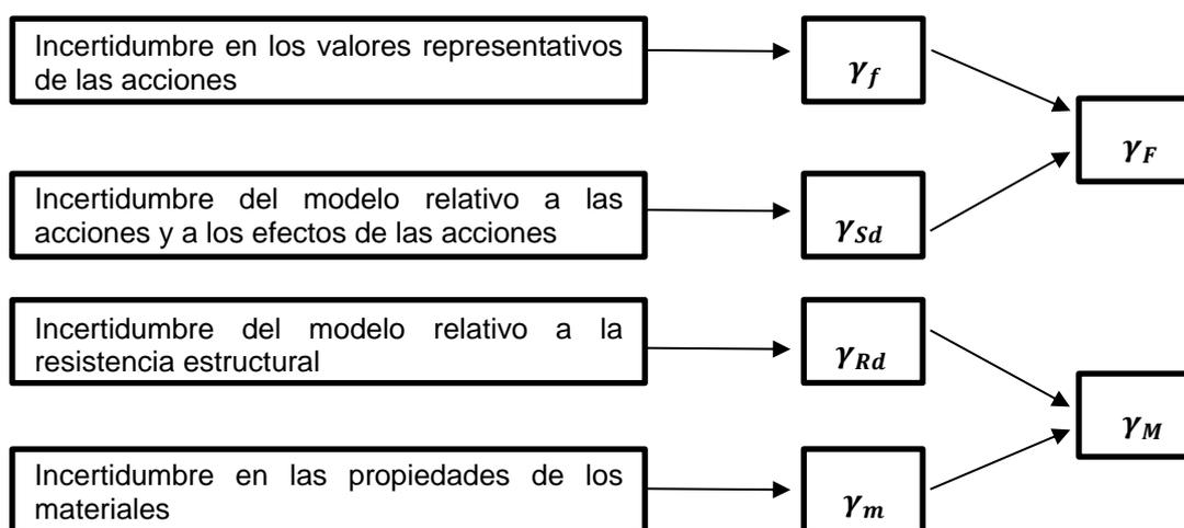
Figura C3 – Relación entre los coeficientes parciales individuales.
